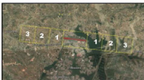
**Figure 4 : Configuration géométrique d'un système LLWAS matérialisant la piste (en rouge) et les limites des emplacements des anémomètres à 1, 2 et 3 NM soit 2, 4 et 6(Km) au-delà des deux extrémités de la piste pour couvrir les corridors d'arrivée ou de départ. Le nombre des anémomètres et leurs positions autour de la piste devront respecter la distance de 2 à 4 km entre les anémomètres adjacents et, de 1 km par rapport à l'axe de la piste.**
